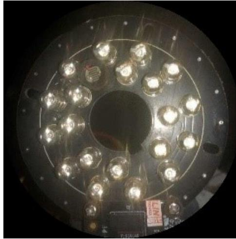
Figura 10 – Circuito refletor de LED infravermelho acionado por sensor fotovoltaico.
