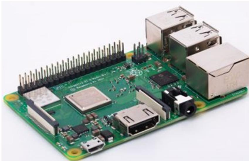
Figura 52 – Computador Raspberry Pi utilizado para controlar todo o sistema ERACI.
