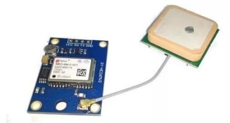
Figura 11 – Módulo GPS modelo NEO-6M GPS utilizado para obter a posição do ERACI no solo.
