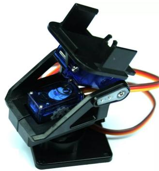
Figura 8 – Estrutura pan/tilt que atua para posicionar a câmera para a captura das imagens.
