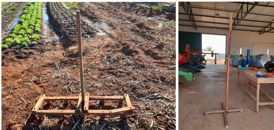
Figura 94 – Protótipos de suportes para posicionamento experimental de dispositivos INS.
