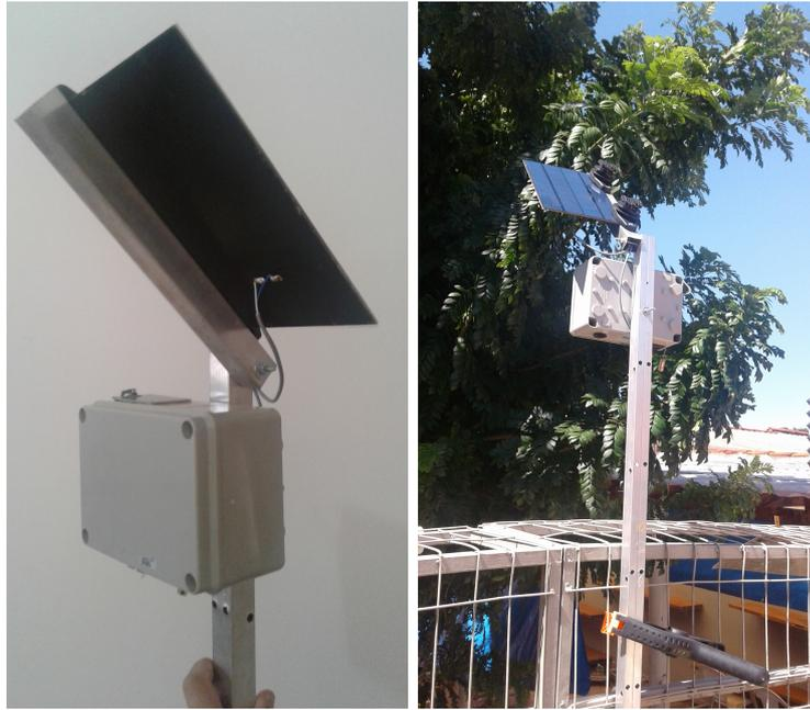
Figura 90 – Dispositivo INS acondicionado em uma caixa de plástico ABS.
